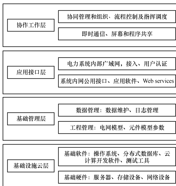
图 3 电力工业系统中云计算结构层次
